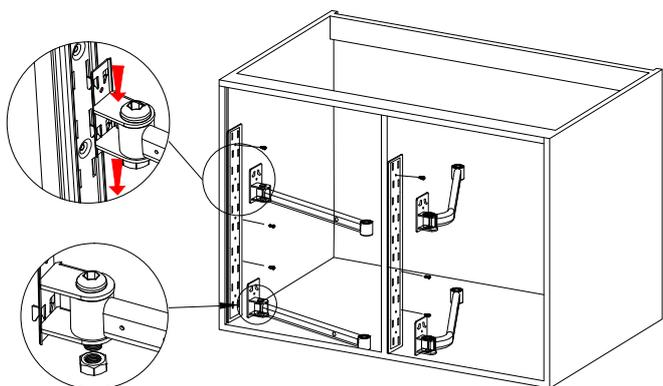
Регулировка положения рычагов на монтажной планке.
